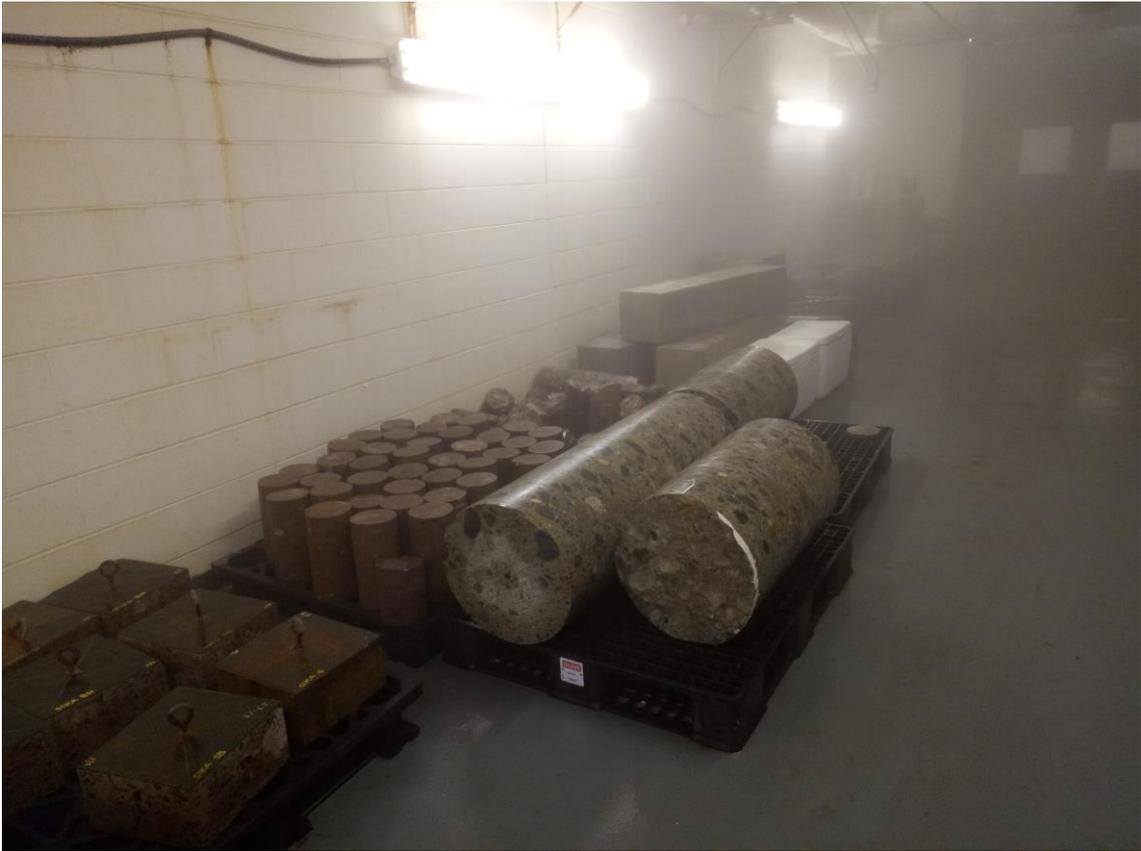
圖 22 混凝土試體於蒸氣室養護情形
