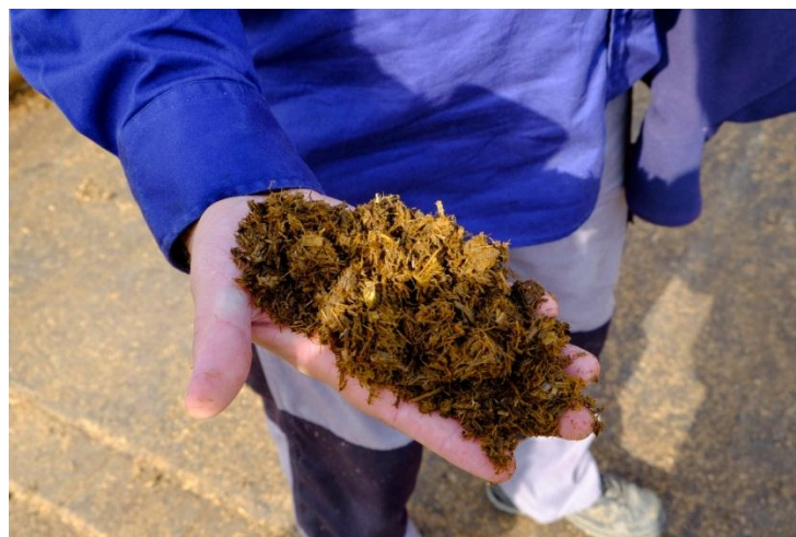
圖六、德國沼氣發電廠經過厭氧消化的沼渣
