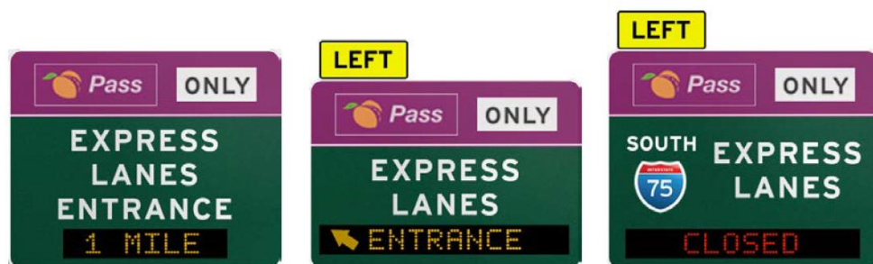
圖 32 進入 I-75 可逆式車道之相關預告標誌
