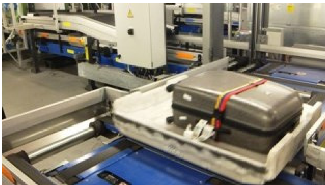
圖 55：杜賽道夫機場 ICS 設備實測
