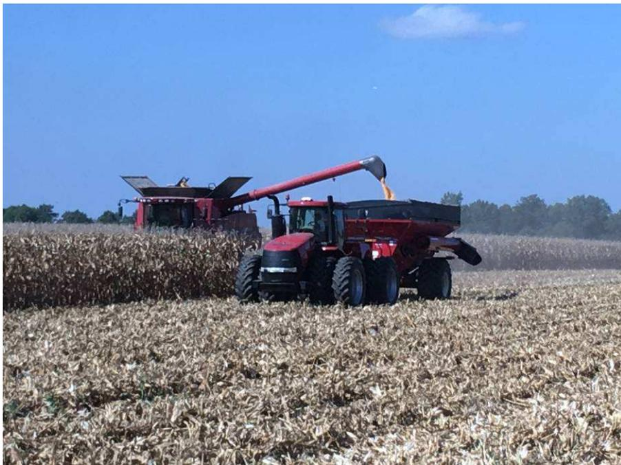
年邁的農場主人 Howard 擁有 4,000 多英畝的土地，土地上長滿金黃色的玉米，農場只有 3 位正式員工，場主 Howard 所擁有高科技、高效率且體形龐大的玉米採收機，為農訪團展示驚人的採收速度，只見玉米梗被砍斷，同時去除玉米苞葉，篩出玉米顆粒，然後經過圓形管輸送到同步行進的槽車，槽車再載運至道路旁的卡車卸貨，一氣呵成，展現高超的效率。
