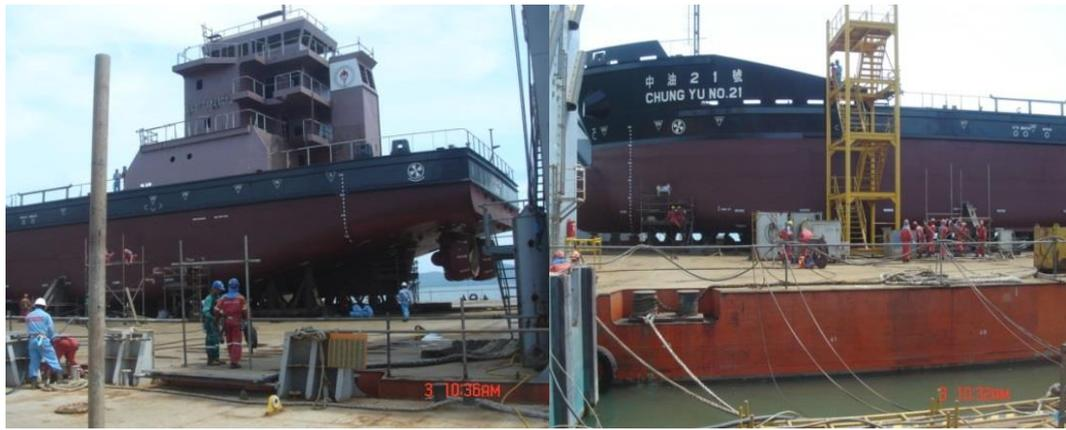
第三日浮塢拖往深水海域，因浮塢吃水4M，加上「中油21號」空船漂浮至少3M，所以海域深度至少要10M以上，且海流影響應至最小，四艘拖船護航戒備，浮台緩緩下沉，約1.5小時「中油21號」終於脫離浮台，隨者拖船牽引慢慢靠上碼頭，平安順利是當日的寫照。
