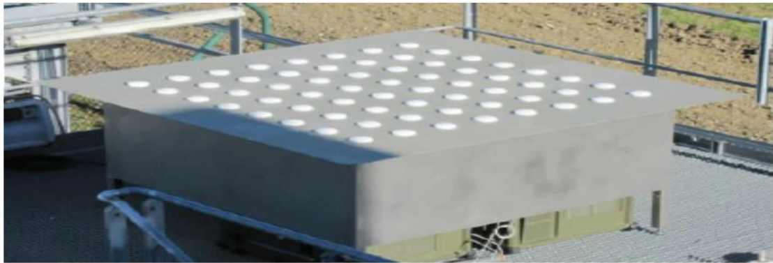
圖3.3 Thales 的MEOUT L-Band 主動相位陣列天線
