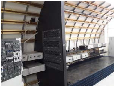
實物 模擬機（飛機電力系統）
