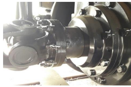
傳動軸注油狀況
