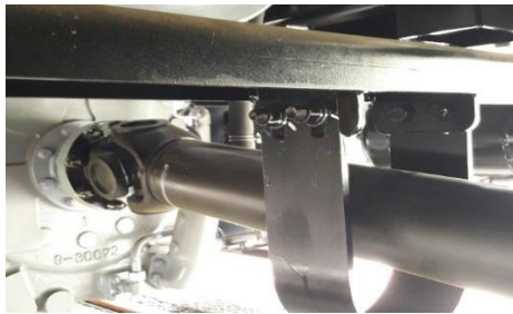
傳動軸注油狀況
