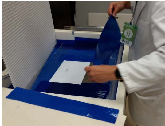
圖 9 館員以模擬文物示範如何使用補動機補洞
