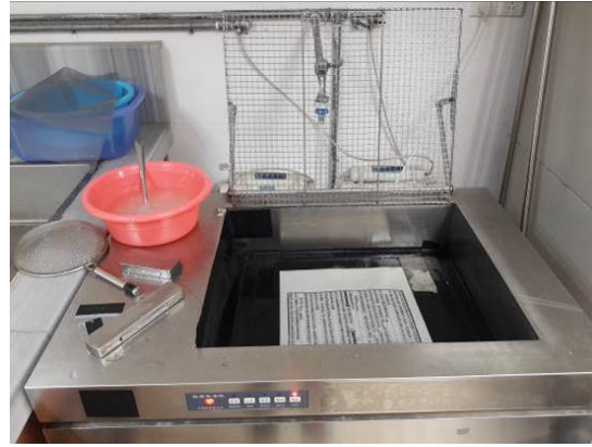
圖 24 使用補洞機填補書頁孔洞
