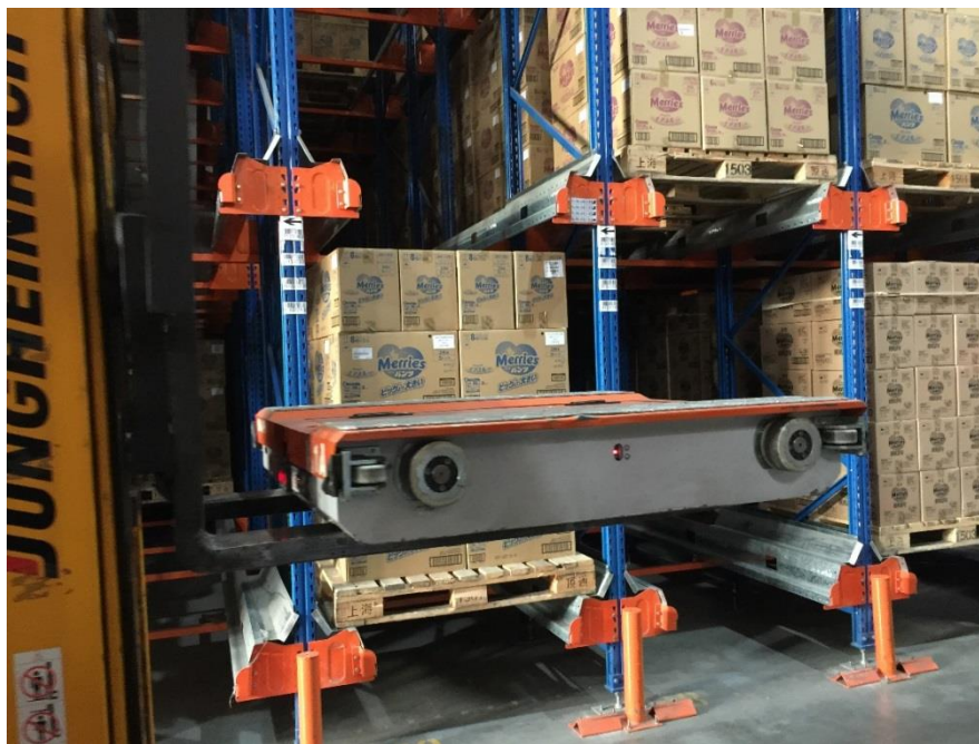
圖 3：堆高機準備將自動搬運的 shuttle 放入駛入式貨架。
