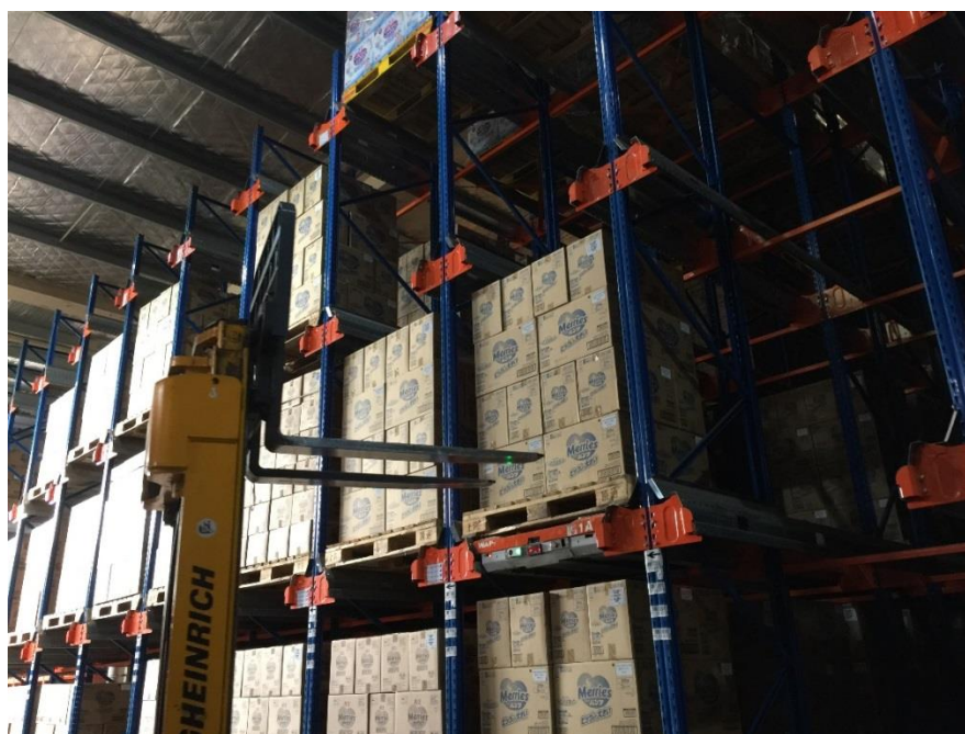
圖 4：Shuttle 移動至貨架深處，將棧板運出至貨架前端，由堆高機移出棧板。
