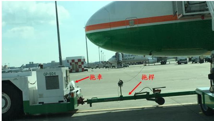
圖 12 拖車以拖桿連結航機
