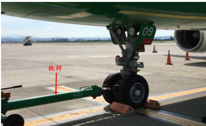
圖 11 拖車拖桿接妥於航機鼻輪
