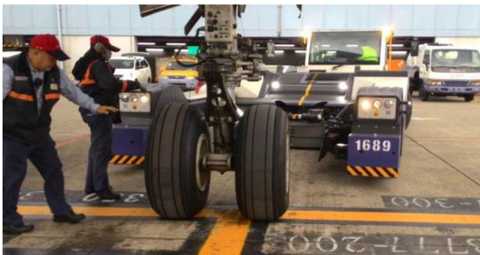
圖 14 無拖桿拖車以機器手臂夾住鼻輪 資料來源：桃園航勤公司
