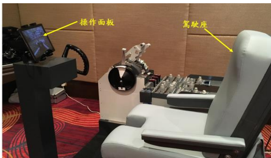
圖 21 WheelTug 電動滑行系統操作面板與駕駛座位置圖
