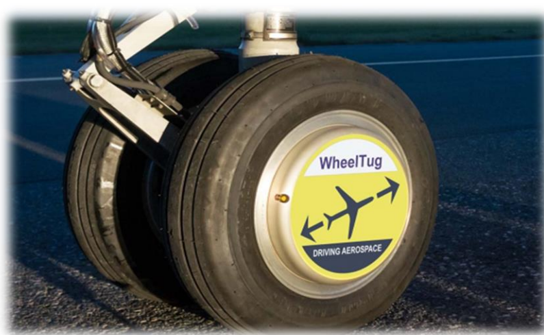
圖 18 WheelTug 電動滑行系統(鼻輪) 資料來源: WheelTug 2017 IATA E-Taxi Conference 簡報
