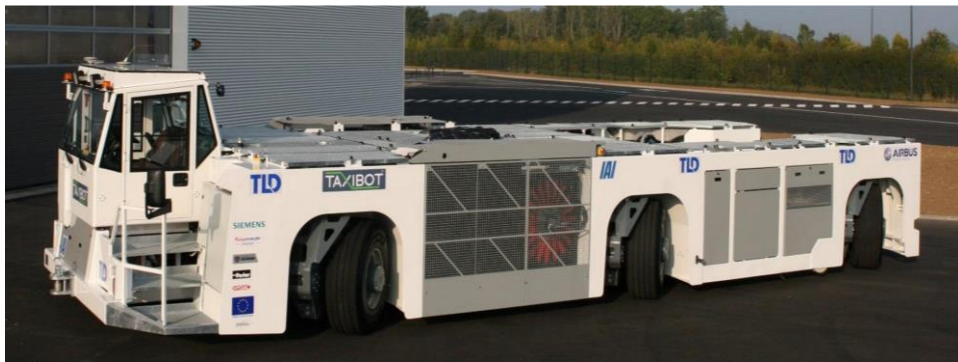
圖 28 TaxiBot 半自動式油電混合拖車
