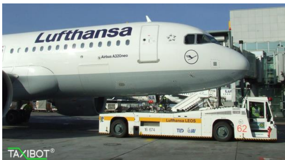
圖 29 航機由 TaxiBot 拖車帶動滑行
