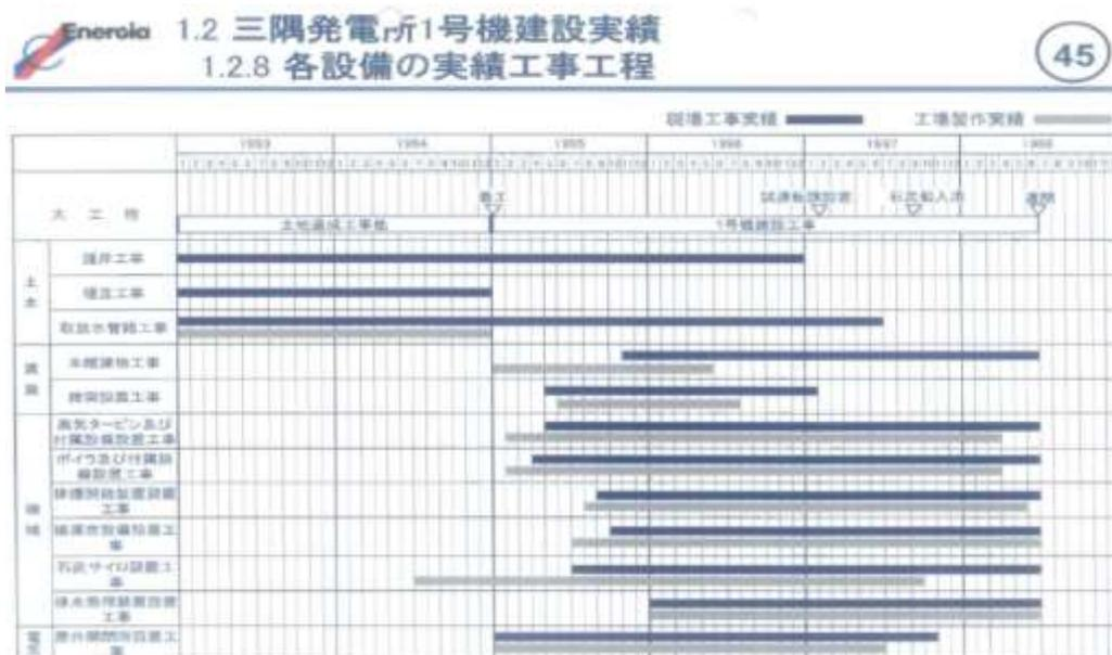
圖 22 三隅電廠 1 號機施工時程表
