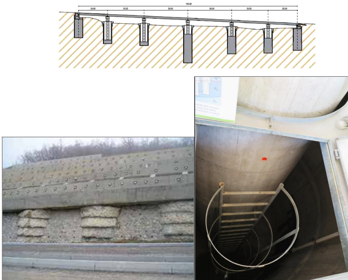
圖 19、沉箱做為抗壓設施保護公路的高架橋柱，減少橋柱上的側向土壓力
