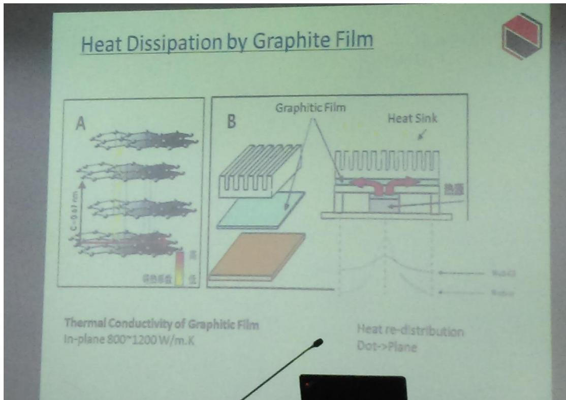
圖 16、石墨烯複合材料有較佳降溫的散熱效果
