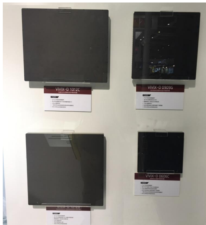
圖 2.40 韓國Vieworks 公司展示動態數位X光偵檢器
