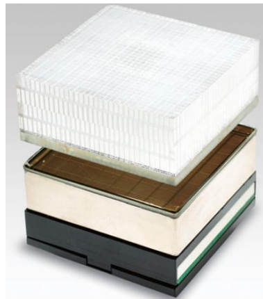
圖 2.10 Elmammo內部成像偵檢器構造
