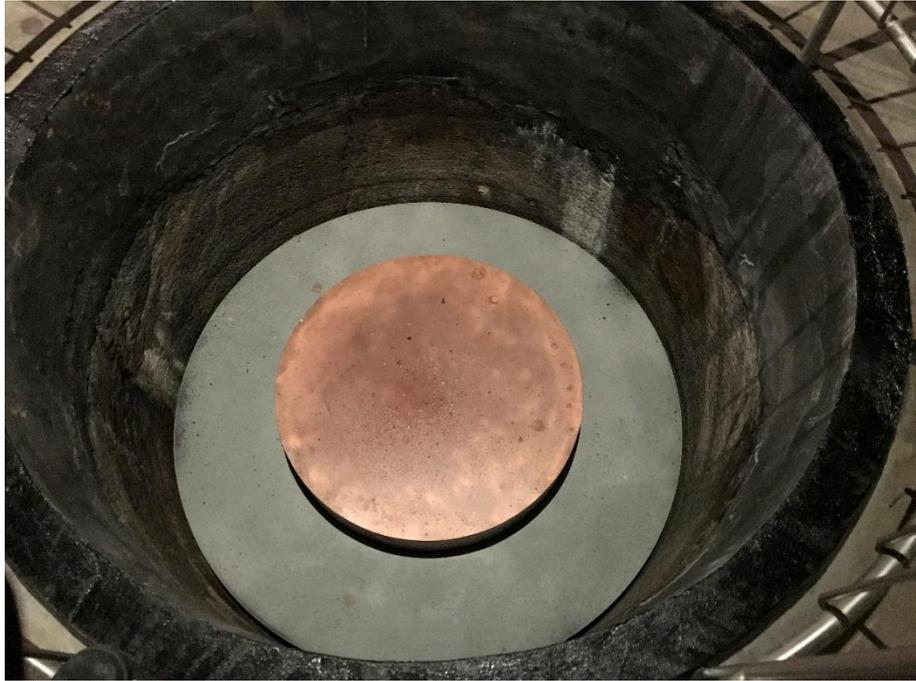
圖 47：裝填緩衝材料與廢棄物罐之處置孔
