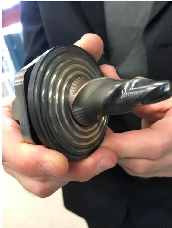
圖 36：摩擦攪拌銲接工具
