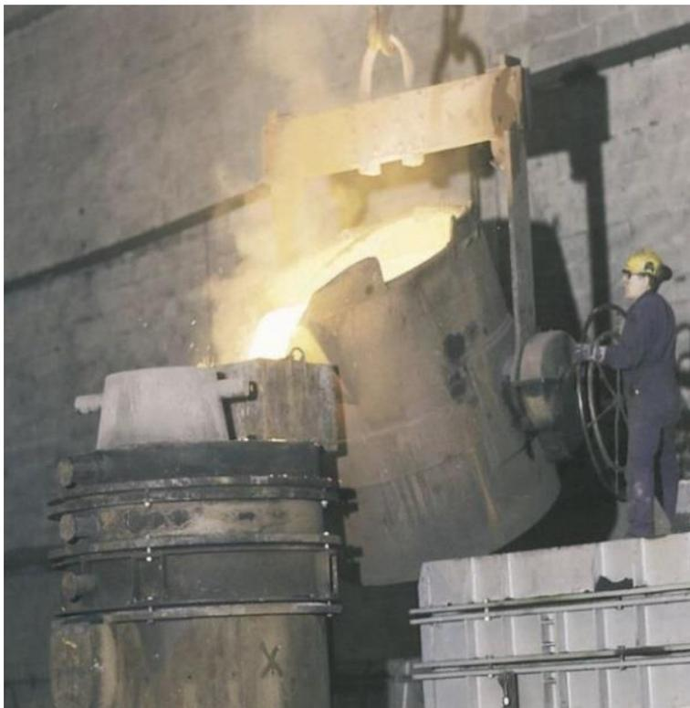
圖 28：高溫熔融狀態的鐵充填至鑄造模具中
