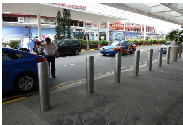
維安設施航廈周邊路緣皆設置防車輛衝撞柱，避免車輛闖入航廈
