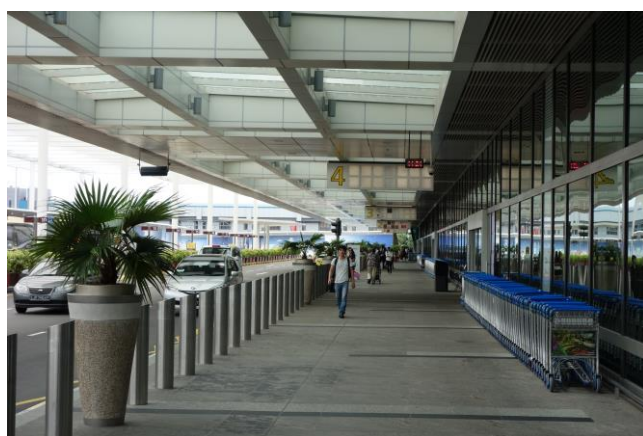
維安設施航廈周邊路緣皆設置防車輛衝撞柱，避免車輛闖入航廈
