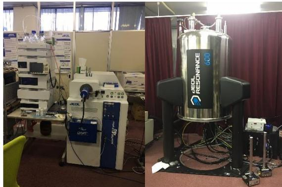
圖十二與圖十三、液體飛行時間質譜儀與核磁共振儀
