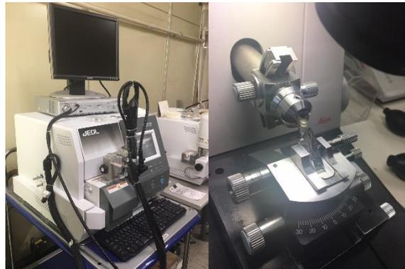
圖三與圖四、離子束切割與鑽石刀製樣設備
