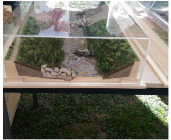
圖 4.2-7 數種植生護岸樣態模型
