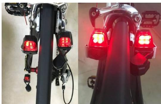
透過法拉第定律、楞次定律之物理原理，於輪框上產生渦電流進而推動微型非接觸式磁感應發電機，使用於腳踏車上不需與車輪接觸，且不需使用電池，免保養，使用方便，並達到環保之目的。
