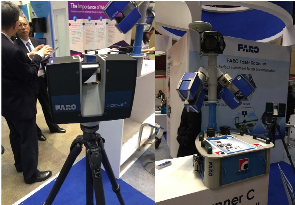
圖53、FARO LiDAR（左圖）及行動式 LiDAR 暨街景設備整合規格
