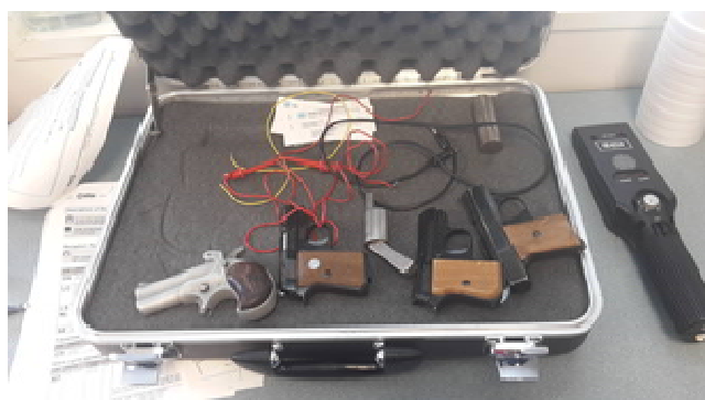
圖10、門框金屬探測器實地測試所用不同材質武器
