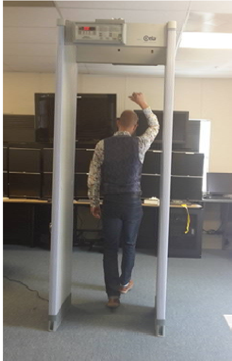
圖11、門框金屬探測器實地測試違禁品不同位置
