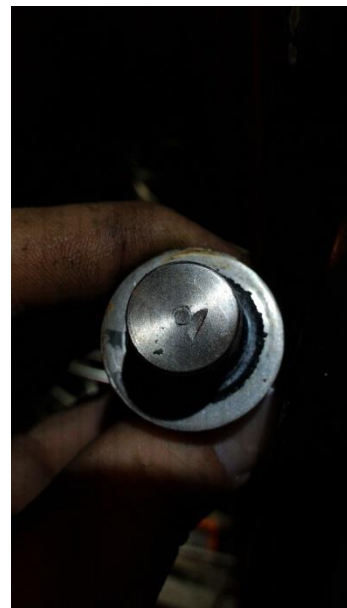
圖 60 拆下之 77FD1 已有損傷
