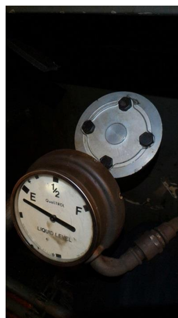
圖 51 潤滑油位計拆離
