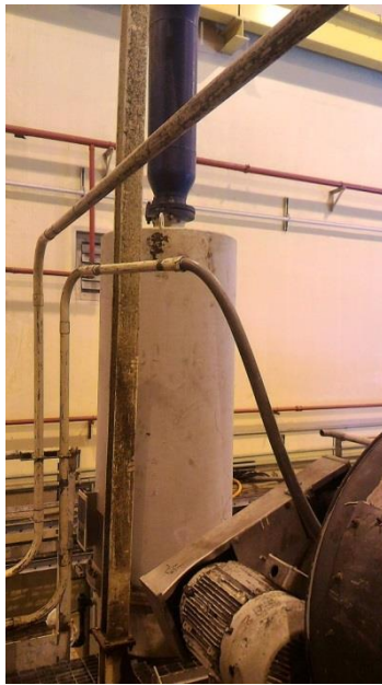
圖 44 下方導線管接第一台馬達
