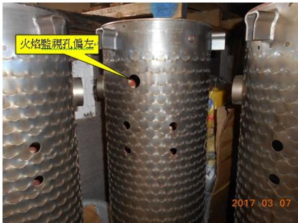
圖 24 火焰監視孔偏左的燃燒器
