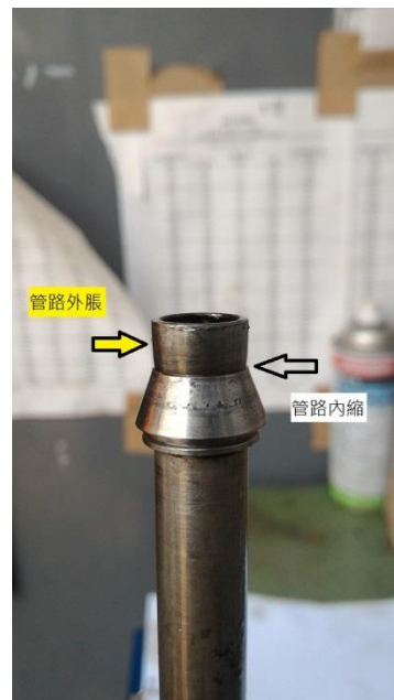
圖 66 燃油管路漏油原因
