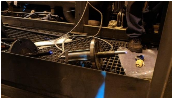
圖 20 點火器測試成功
