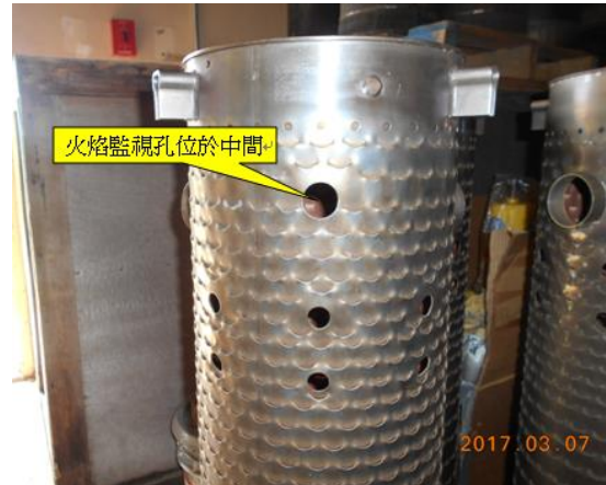
圖 25 火焰監視孔位於中間的燃燒器
