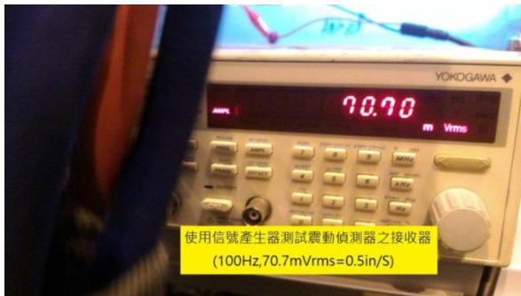
圖 29 以信號產生器測試 vibration receiver
