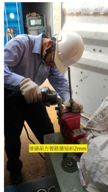
圖 67 燃油管路研磨
