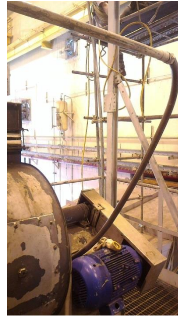
圖 45 上方導線管接第二台馬達
