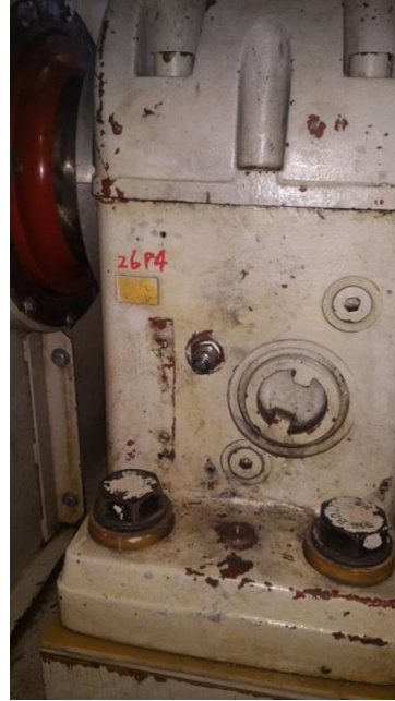
圖 12 起機期間 CT-2 26P4 偵測孔 PLUG
