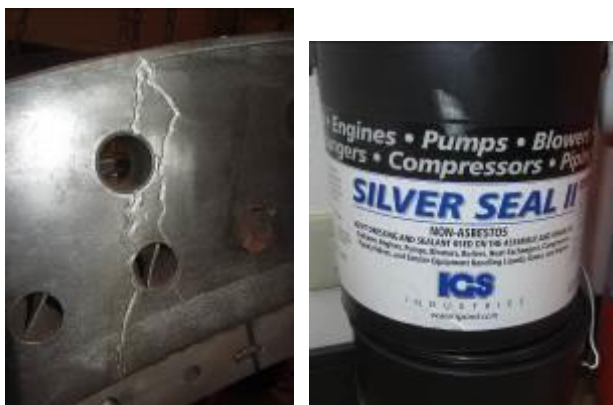
照片 3：氣機第二級靜葉環上半 L 側第 1 只靜葉片本體有 9mm 裂痕
