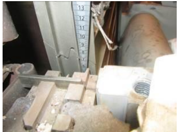
照片 2：氣機#2 級動葉與汽封環間隙量測
