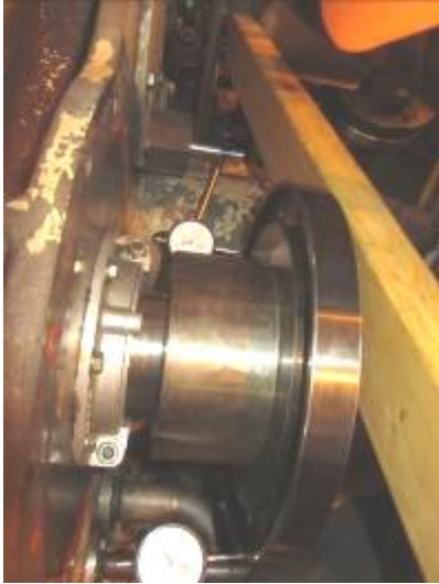
照片 19：量測齒輪箱軸向間隙
