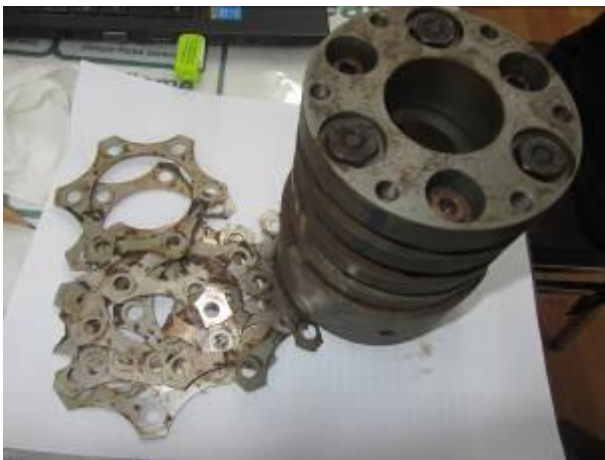
照片 23：輔助潤滑油泵聯軸器墊片破裂
