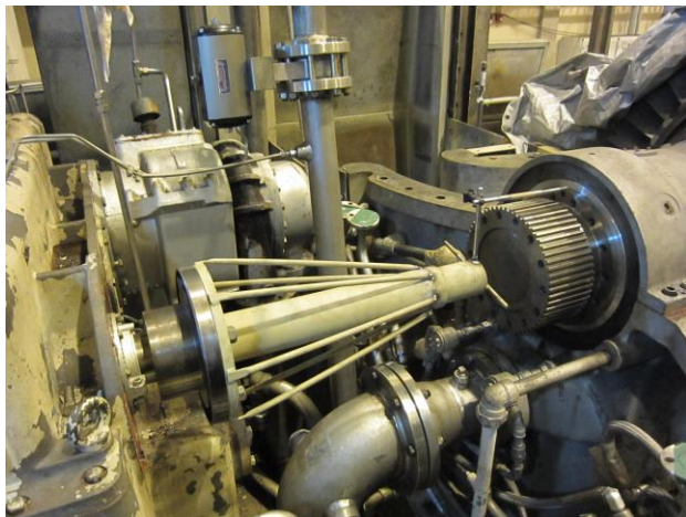
照片 33：空壓機-輔助齒輪箱對心
