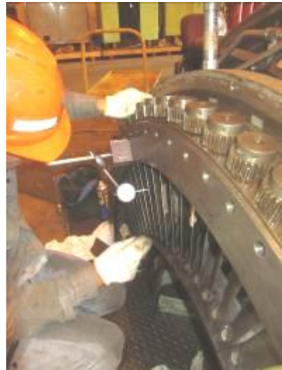
照片 10：IGV 齒隙量測
