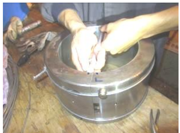
照片 16：軸承內徑量測
