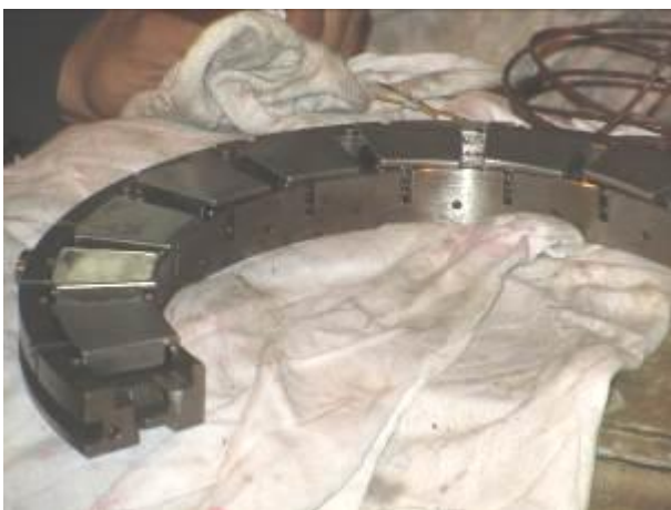
照片 17：推力軸承整理檢查
