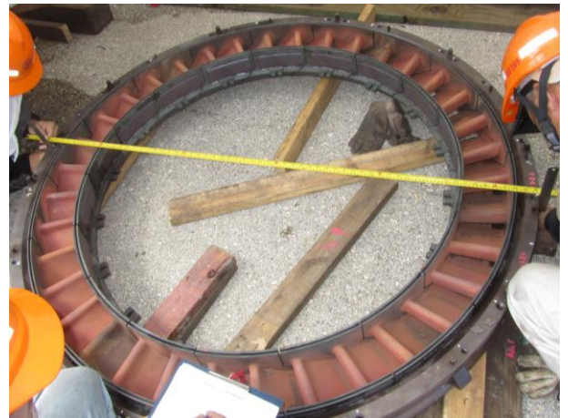
照片 2：氣機#2 級動葉與汽封環間隙量測
