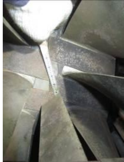
照片 8：空壓段轉子與靜葉片間隙量測
