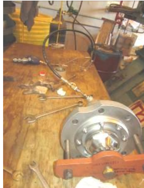
照片 14：燃油噴嘴試壓
