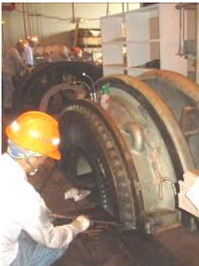
照片 11：IGV 齒隙清理
