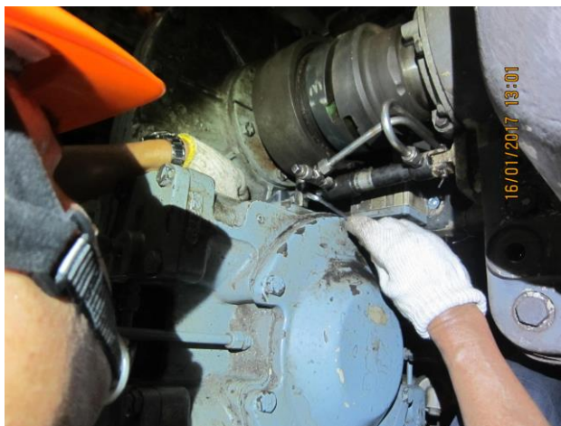
照片 41：JAW CLUTCH 間隙調整
