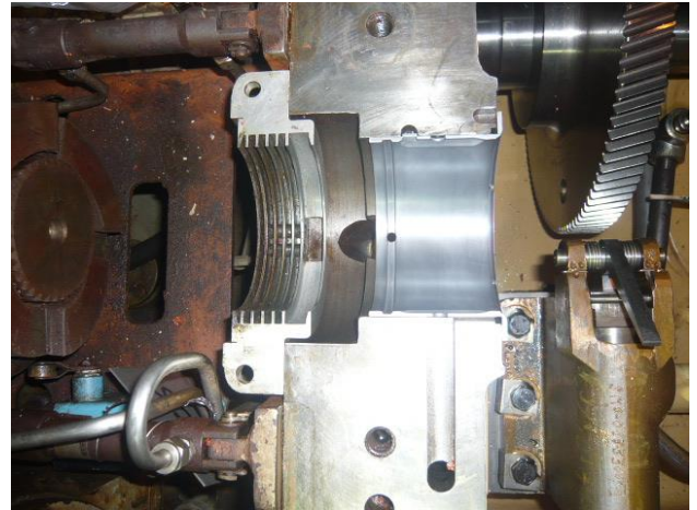
照片 26：輔機齒輪箱 Shaft #1 前後軸承更新
