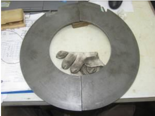
照片 19：更換推力軸承負載側墊片
