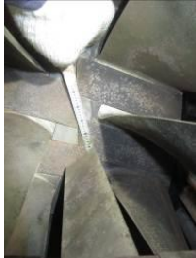
照片 8：空壓段轉子與靜葉片間隙量測
