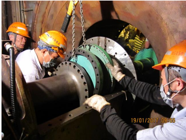
照片 31：負載齒輪箱延伸軸復裝
