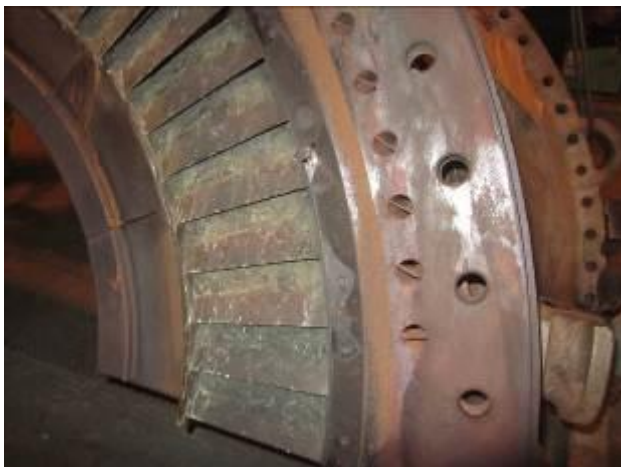
照片 3：靜葉片局部塗層脫落
