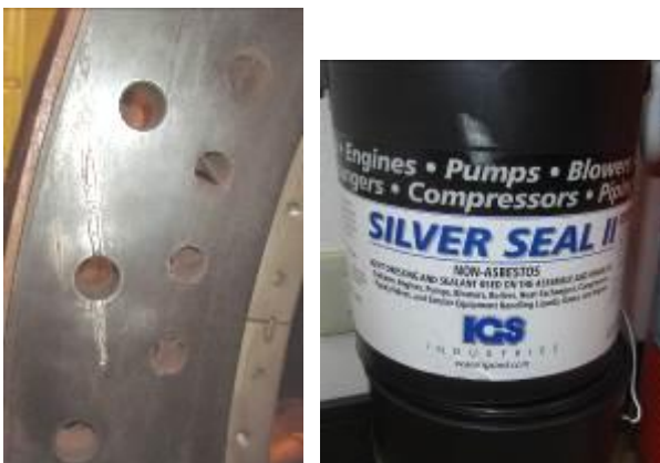
照片 5：氣機外缸刮痕塗抹 silver seal II (密封劑)
