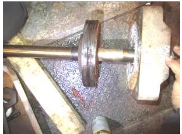
照片 40：氣機冷卻空氣逸放閥拆解整修
