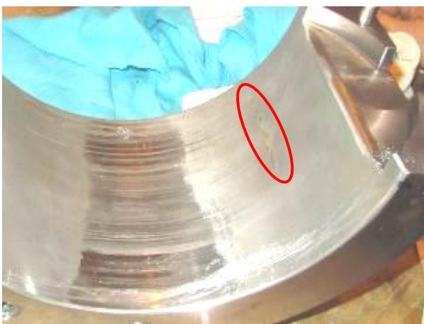
照片 17：#2 軸承下半有 4 處線形指示
