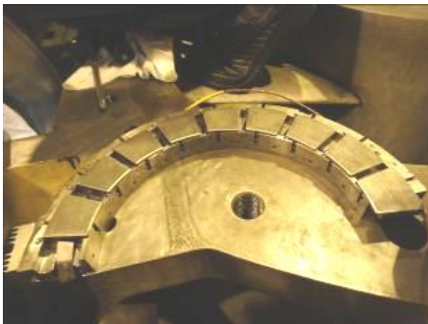
照片 21：推力軸承整理檢查
