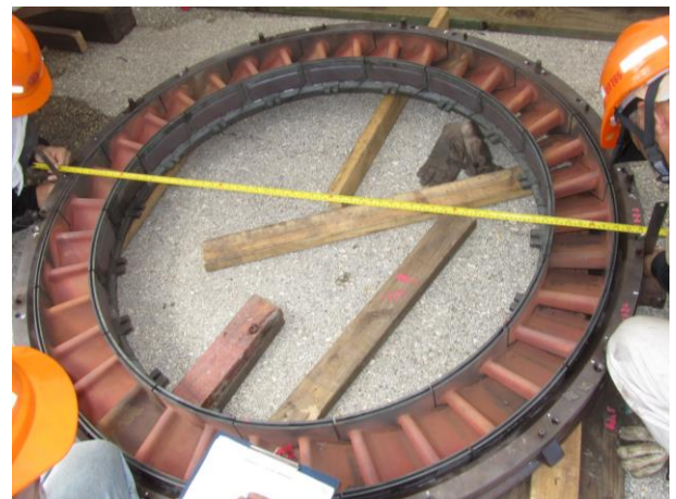
照片 4：靜葉環量測真圓度
