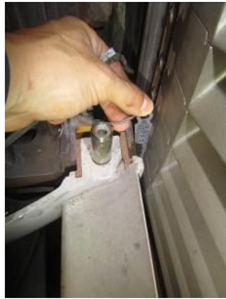
照片 2：氣機#2 動葉與汽封環間隙量測
