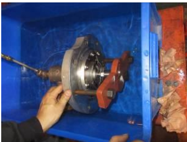
照片 15：燃油噴嘴試壓
