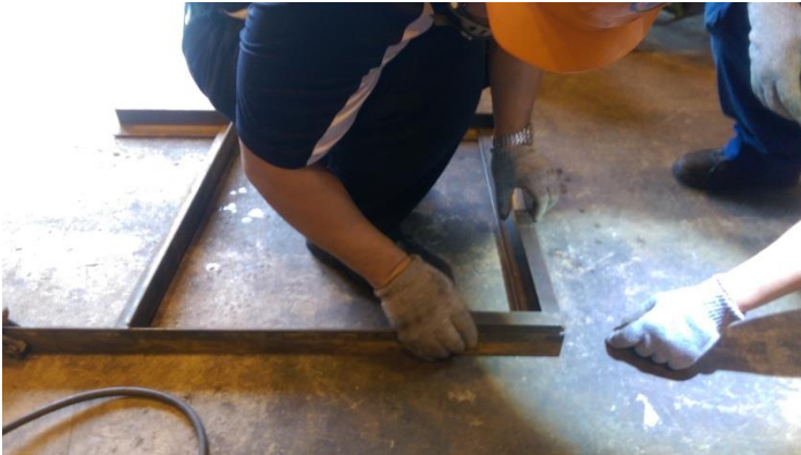
圖 2.2.11 角鐵腳架製作，放置磁場線圈之用
