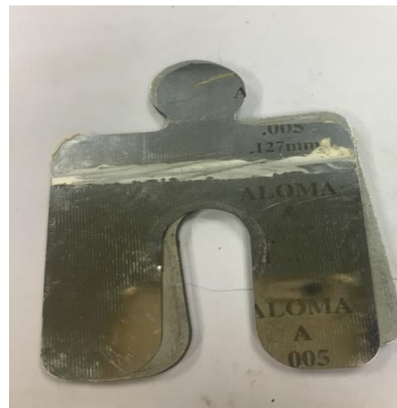
圖 2.2.13 測量及清潔磁場線圈底座墊片
