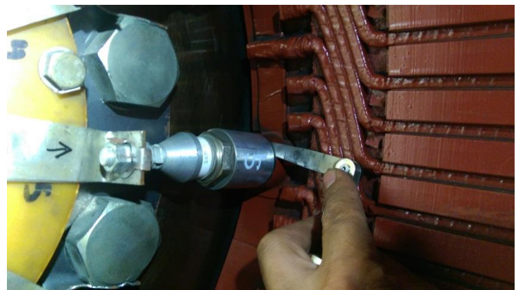
圖 2.1.2 勵磁機整流模組引線近照
