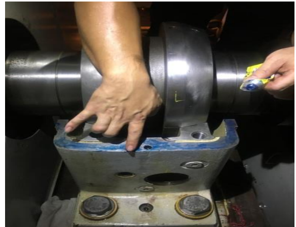
圖 2.2.2 軸承座上蓋拆卸及回裝
