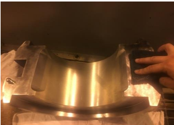
圖 2.2.6 發電機勵磁機側軸承整理
