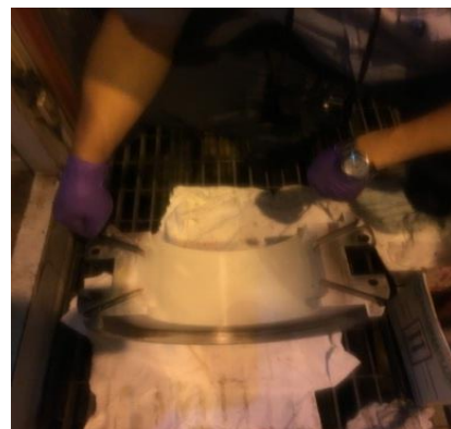
圖 2.2.7 發電機勵磁機側軸承 NDE 檢測
