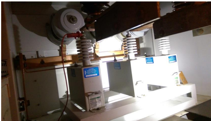
圖 2.3.8 三相電容器絕緣測試
