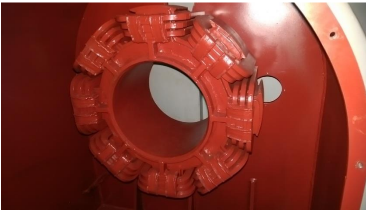
圖 2.1.6 磁場線圈清潔及整理
