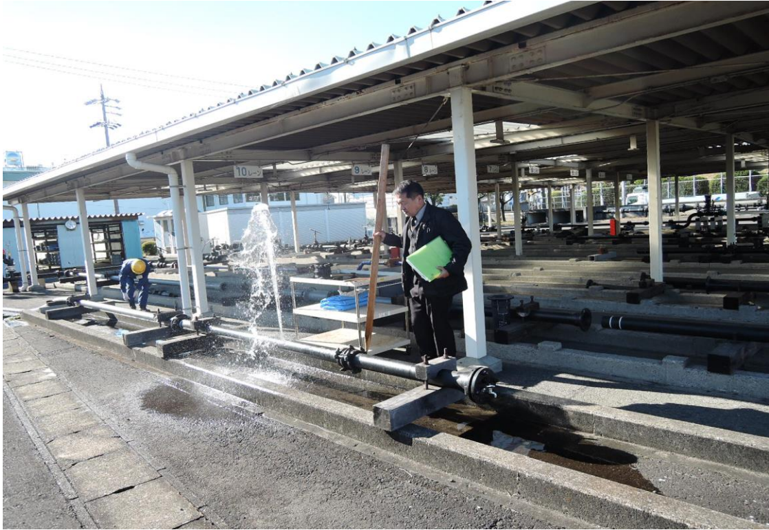
圖 48 名古屋市上下水道局於職員研修所漏水管訓練場
