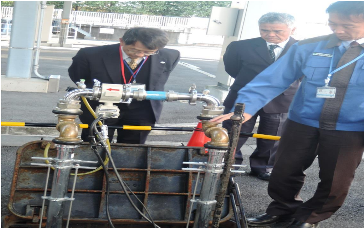
圖 17 東京都水道局教育訓練設施模擬夜間不同漏水探測
