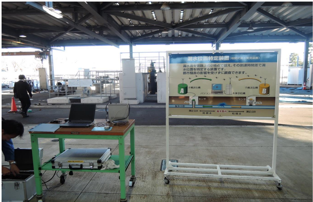
圖 16 東京都水道局教育訓練設施管種不同漏水探測
