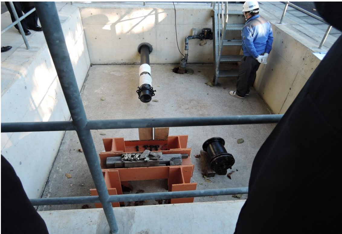
圖 22 東京都水道局教育訓練設施盲蓋安裝防止跳脫實習場
