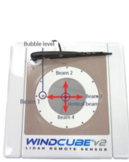
圖 10 激光脈衝雷射位置分布與示意圖
