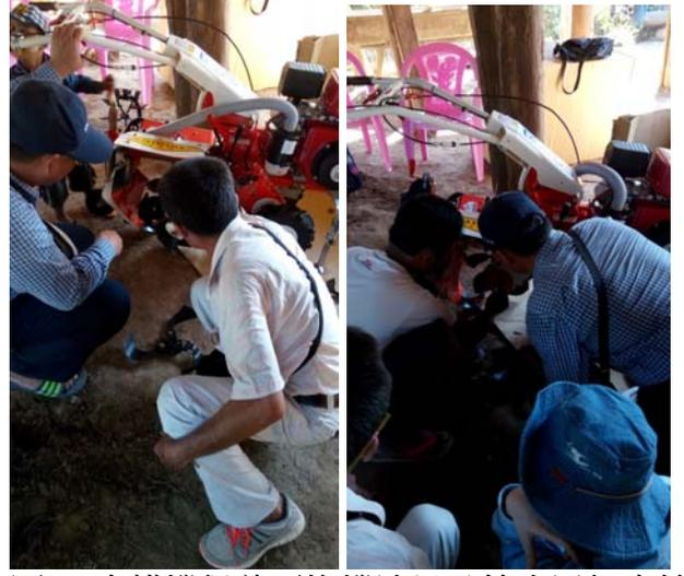
圖 14.中耕機保養更換機油以及檢查添加齒輪油和空氣濾清器的維護保養教導。
