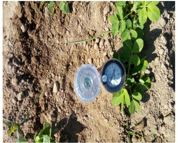
圖 10.設置水分張力計，則安裝埋設在 Ko Wai 栽種的落花生田區內，監測該田區的土壤水分資料。
