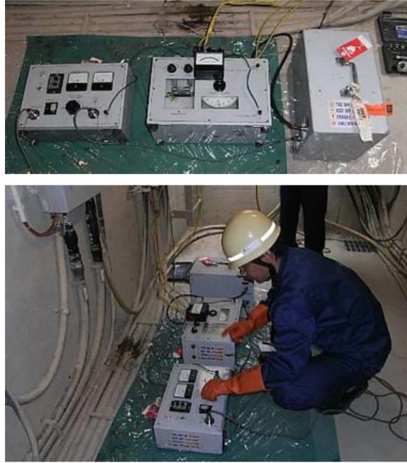
圖十八、Murray Loop 電橋解析法量測示意圖
