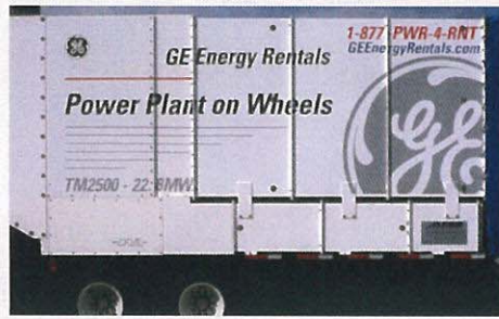
圖 3 GE 於 2000 年推出 TM2500 氣輪機發電機組的行動發電廠
