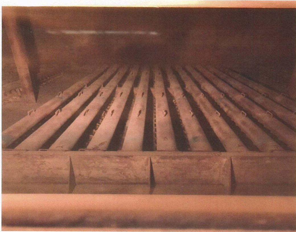
圖 58 PRS 探視窗內觀測洩漏位置 OPTIPOW脈衝清潔系統
