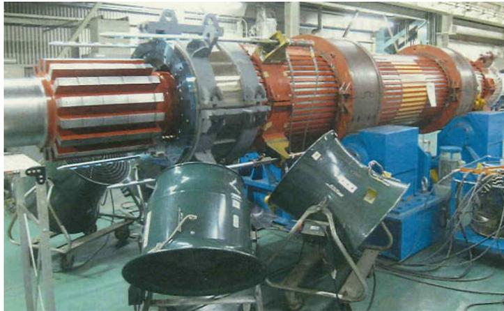
圖 2-19 壓縮環加熱、安裝方式
