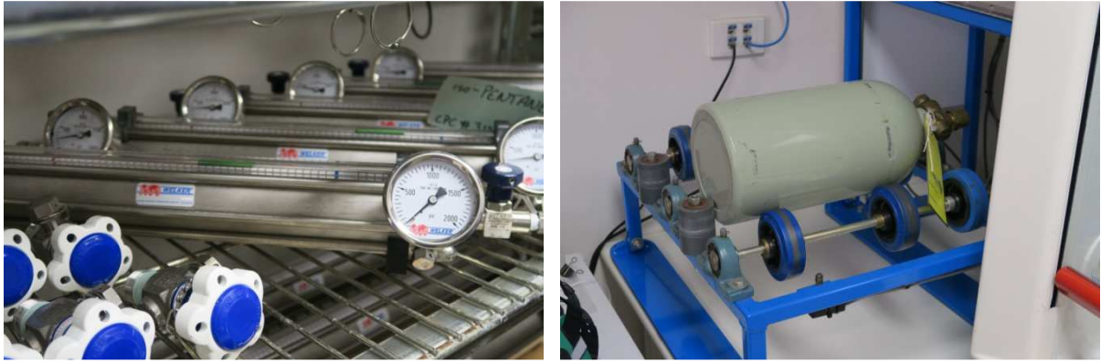
圖6 多數氣體配製皆由液體標準品加以氣化而得，左圖為NMI配製氣化標準品之設備，其上有壓力錶可供換算其氣體濃度；右圖為配製後之氣體鋼瓶置放於滾瓶機上，供瓶內氣體均勻混合用。
