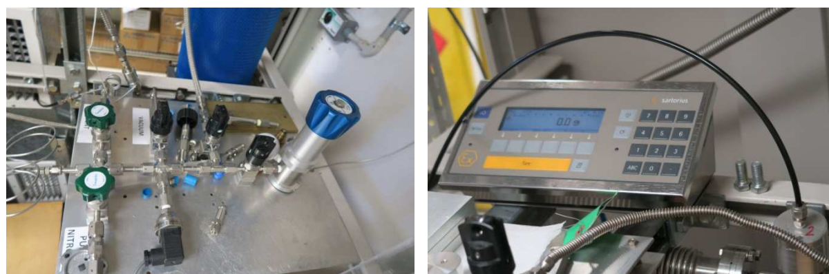
圖 5 藉由左圖之閥件控制導入鋼瓶內之標準氣體(或氮氣)之體積量，再由右圖之天平進行重量量測，以獲得鋼瓶內氣體重量，並可用來計算鋼瓶氣體濃度。
