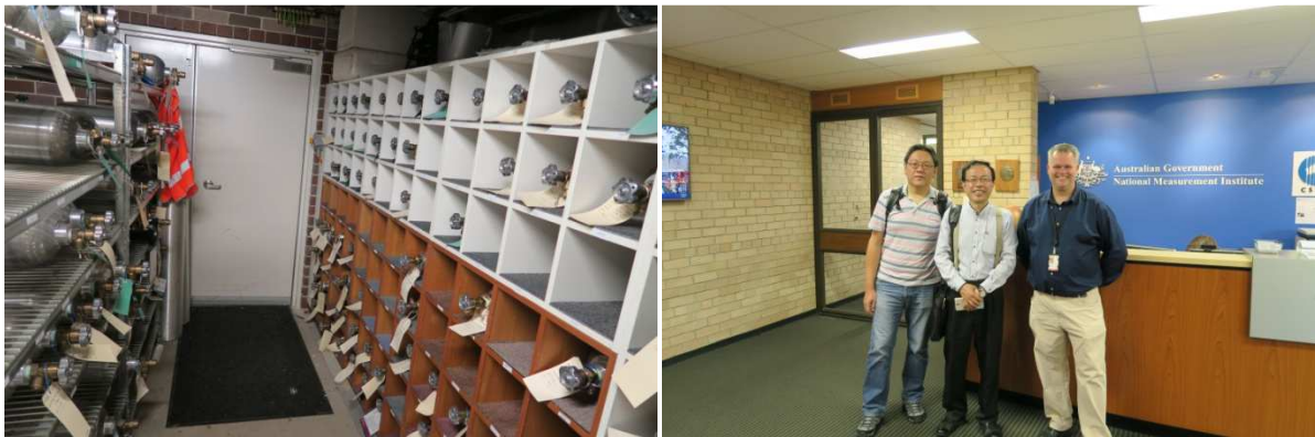
圖7 配製後之氣體鋼瓶於未使用時多以倒放之方式存放(如左圖)，以免造成鋼瓶內待測物分層而濃度不均之情形；至NMI位於Lindfield之Reference Gas Mixtures考察，主要訪談對象為Dr. Damian Smeulders(右圖右1)。
