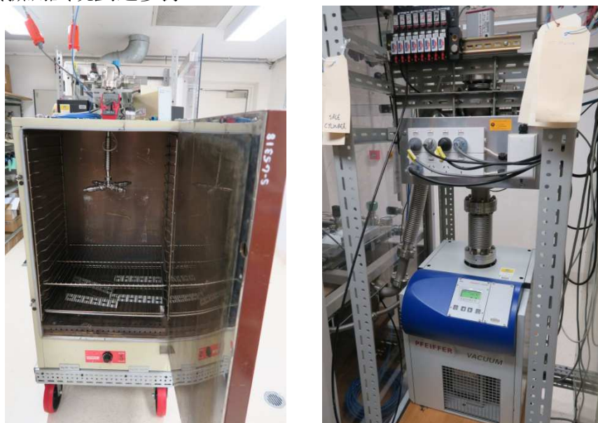
圖 4 至 NMI Reference Gas Mixtures 考察，此為清洗能力試驗用鋼瓶之設備。左圖為烘箱，可見其內有閥件可供鋼瓶以快速接頭做連接；右圖為一真空泵浦，烘箱內管線連接至此藉以抽除鋼瓶內之殘存氣體。
