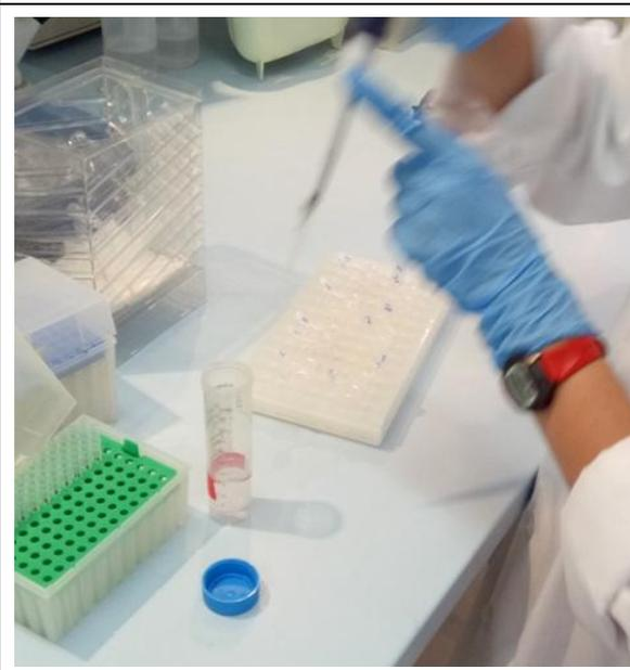
糊化澱粉溶液移入 2 ml 微量離心管，另加入醋酸鈉緩衝液及冰醋酸混合液
