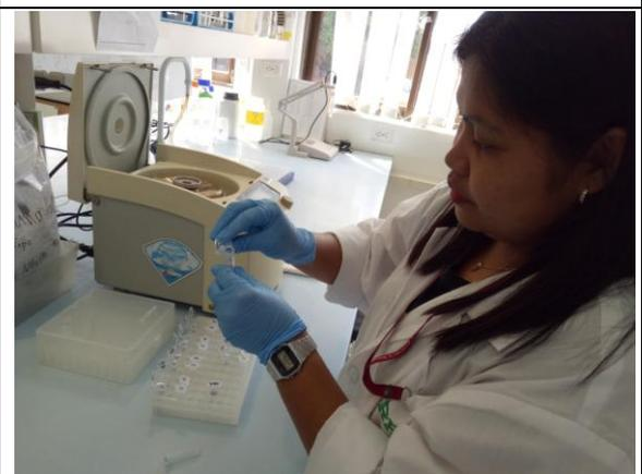
將上澄液置入具有離子交換樹脂的微量離心管
