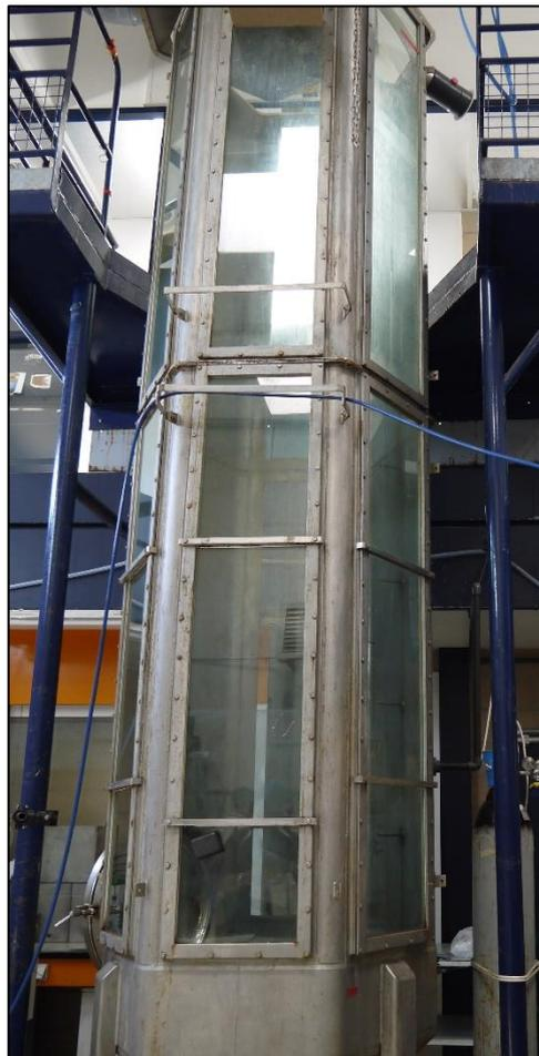
圖 4-6 柱型實驗水槽
