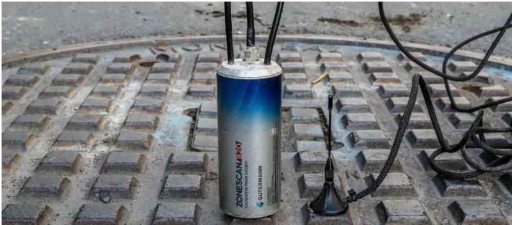
圖 30、漏水偵測紀錄器
