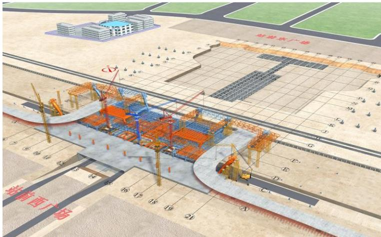
A-F轴继续由东向西进行钢构吊装，土建结构封闭穿插进行，待3-4道站台结构完成，立即移交站场进行线路施工，为第一次转线做好准备。
