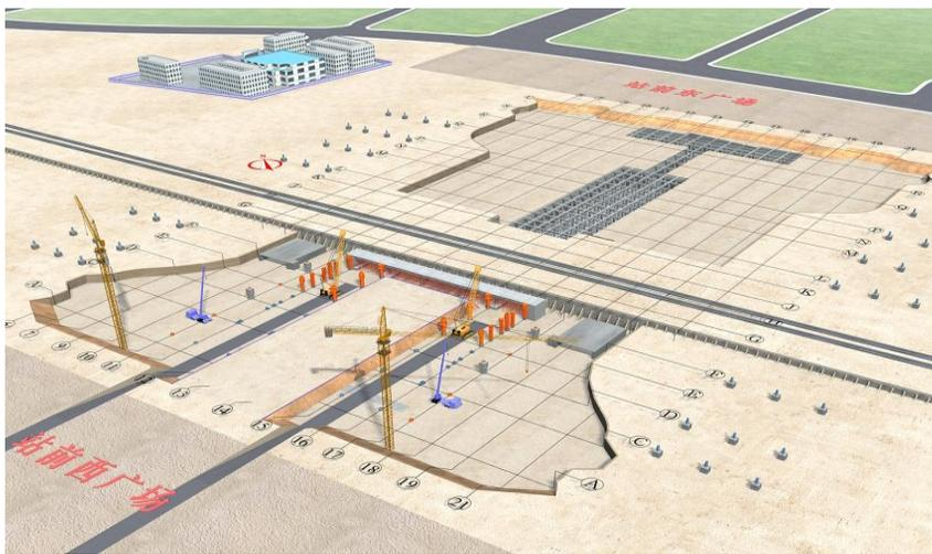
1. A-F轴地下连续墙围护在13-14轴之间继续施工，两侧站台层进行吊装。
