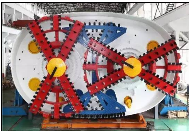
3 號線採全球首例類矩形潛盾機斷面
