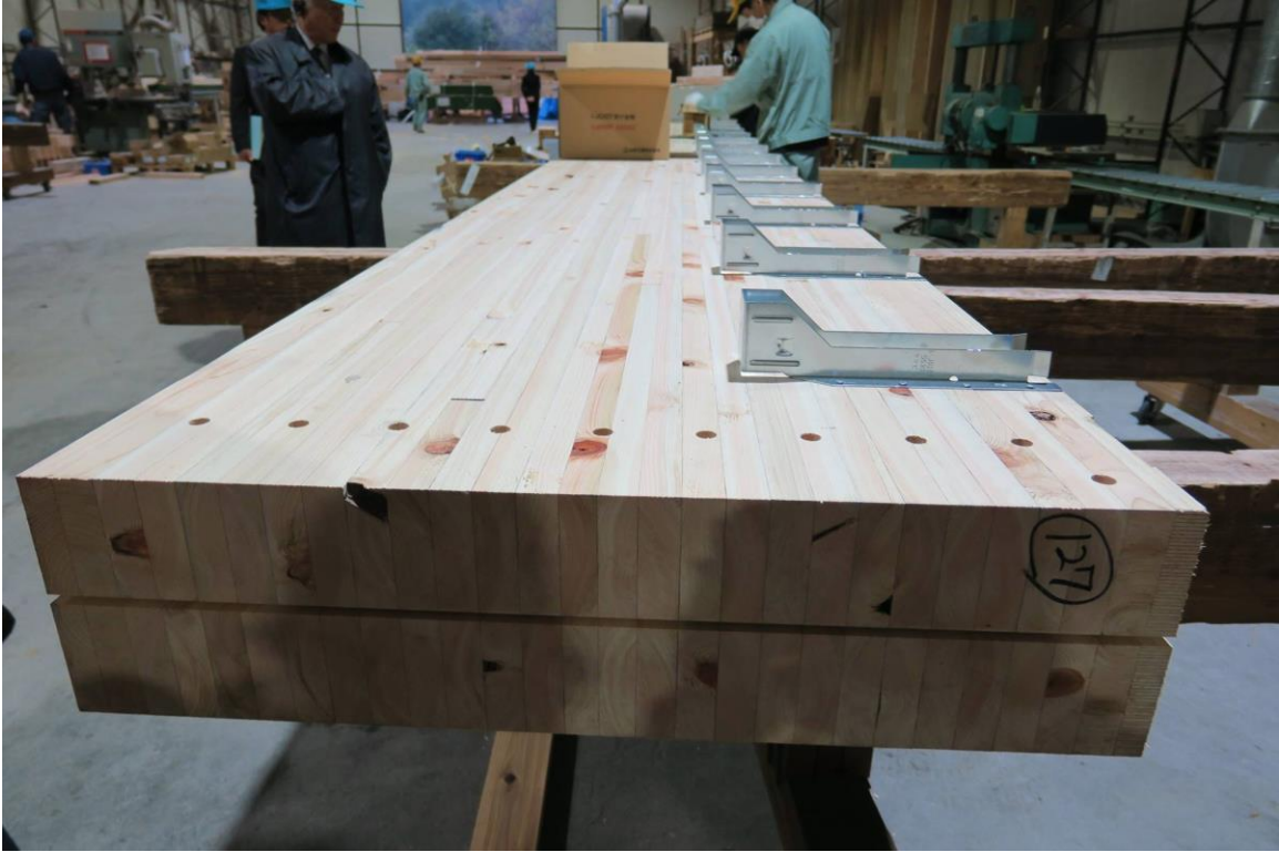
照片23 預切削加工集成材與五金配件組合
