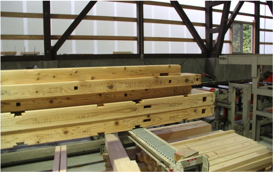
照片22 不同工法的預切削加工製材品
