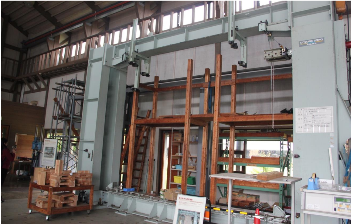
照片18 實大尺寸木結構水平剪斷重複載重性能試驗
