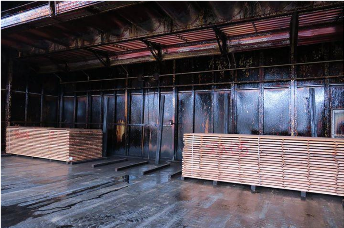
照片26 100立方公尺容積之人工乾燥窯
