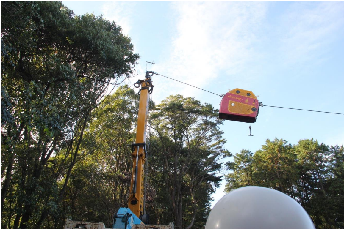
照片7 奧地利Konrad公司製之4000型塔式集材機
