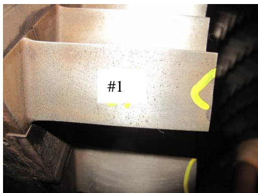
#1 塗層脫落，範圍 (2 \times 7) \text{ mm}^2
