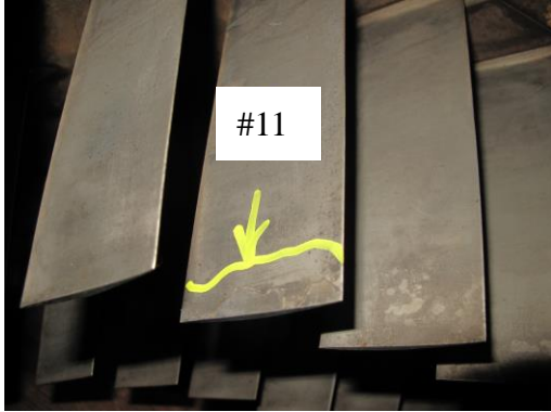
#11 塗層脫落，範圍 (9 \times 53) \text{ mm}^2
