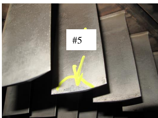
#5 塗層脫落，範圍 (7 \times 20) \text{ mm}^2
