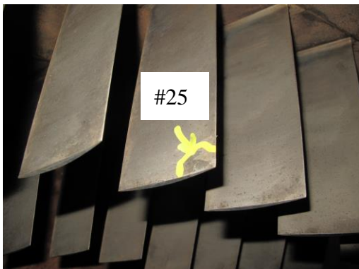
#25 塗層脫落，範圍 (10 \times 14) \text{ mm}^2
