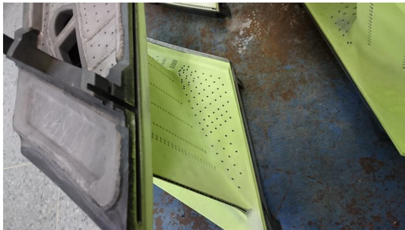
圖 11 三菱公司 M501G 一級動靜葉片照片(a) 一級動葉(b) 一級靜葉。
