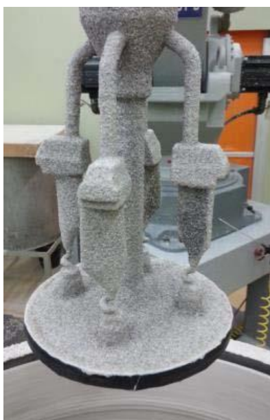
圖17 Sung-il公司動葉片精密鑄造製程照片 (a) 砂心與臘膜 (b) 葉片組臘樹(c)製作殼模
