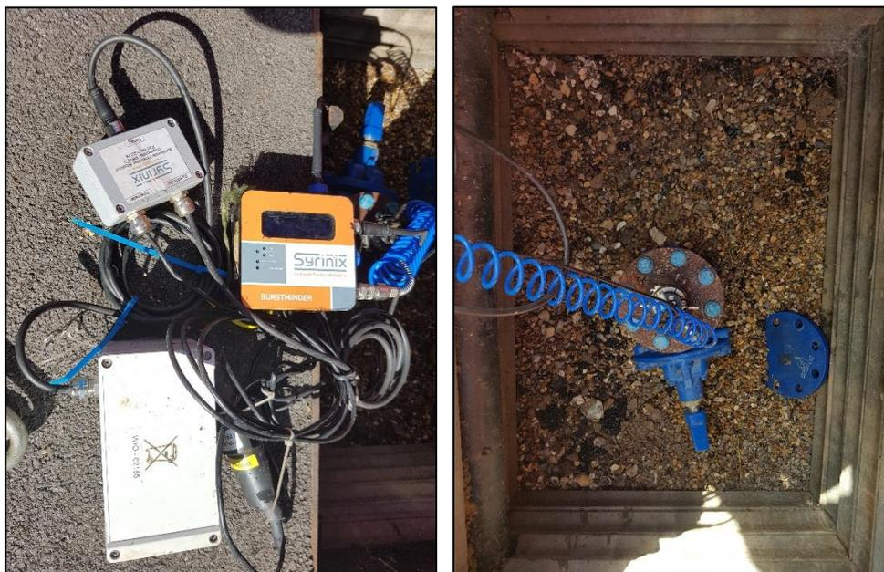
雷丁市水壓監測系統配置圖
