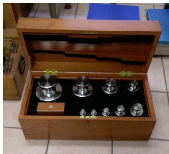
圖 9、史國質量標準之設備，左：電子秤，右：法碼
