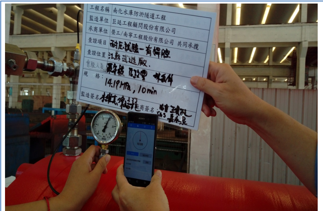
日期：105.9.22 有桿腔耐壓試驗 地點：武進油壓缸製造廠
