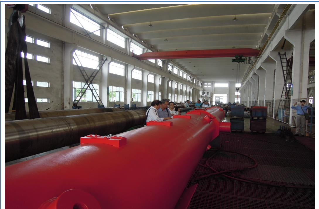
日期：105.9.21 洩漏試驗後檢查油壓缸情形表面無破壞、變形及外部洩漏，銲道無裂縫，螺栓無斷裂。 地點：武進油壓缸製造廠
