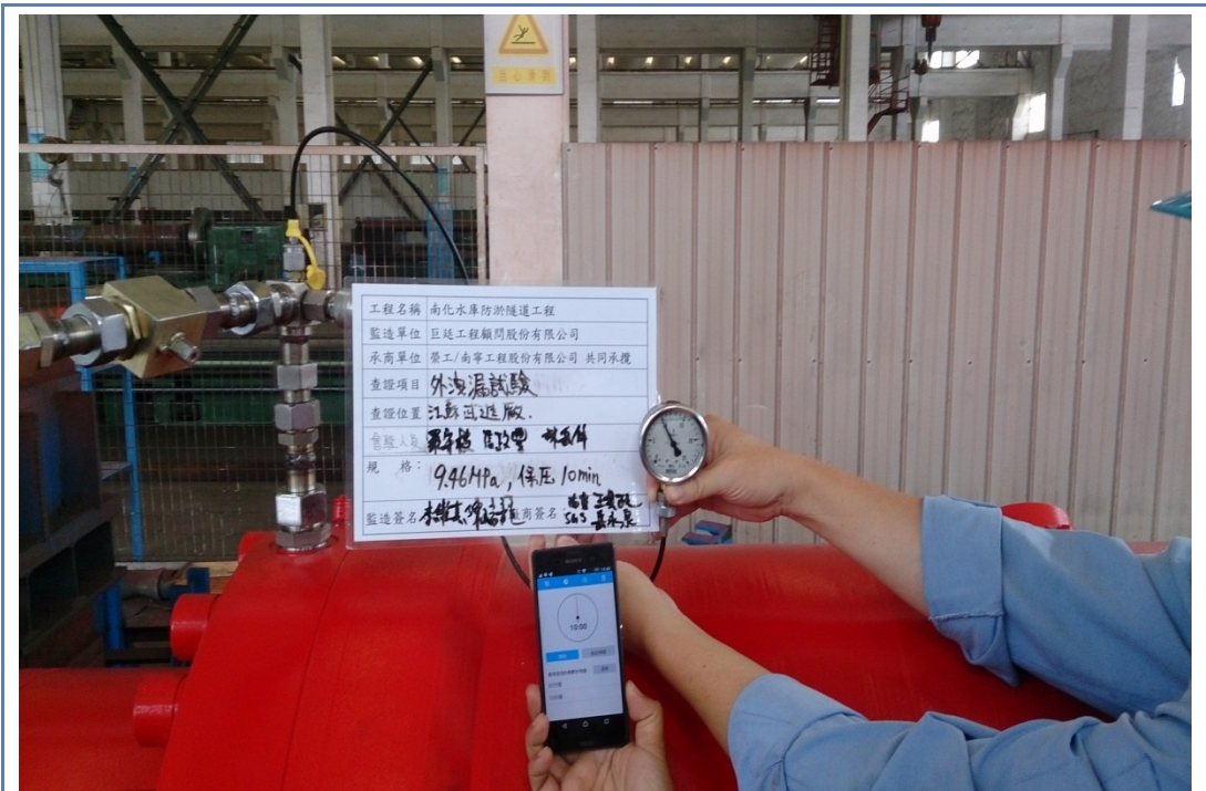
日期：105.9.21 外洩漏試驗 地點：武進油壓缸製造廠
