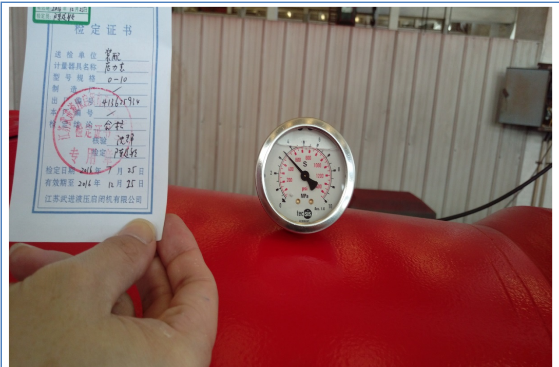
日期：105.9.21 無桿腔內洩漏試驗(壓力 3.3Mpa) 地點：武進油壓缸製造廠
