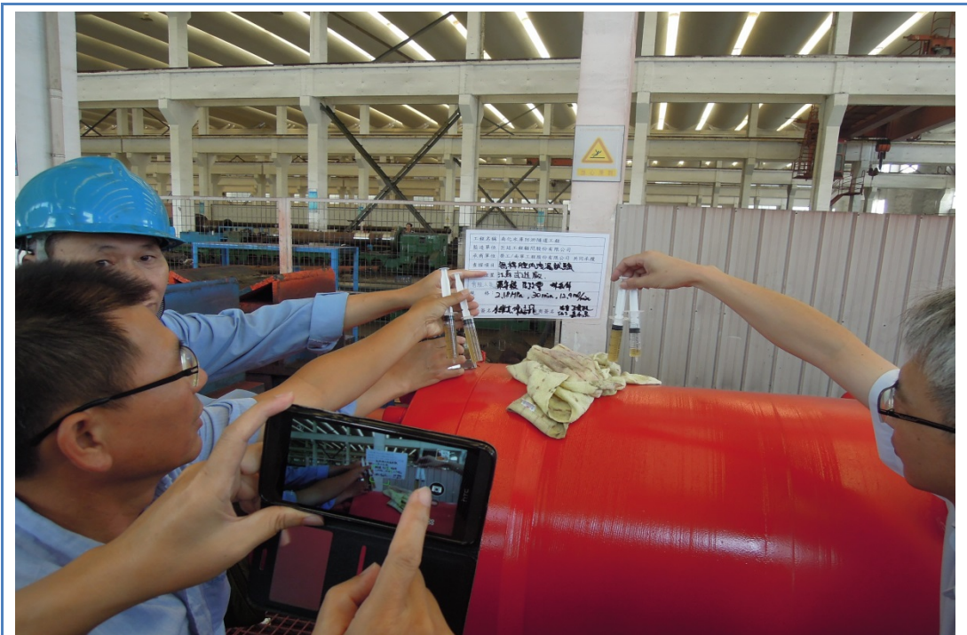
日期：105.9.21 無桿腔內洩漏試驗液壓油量測 地點：武進油壓缸製造廠
