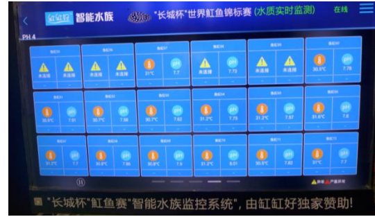
圖 8.紅魚比賽的部分更採用水質自動監控系統，對於各魚缸狀況一目了然
