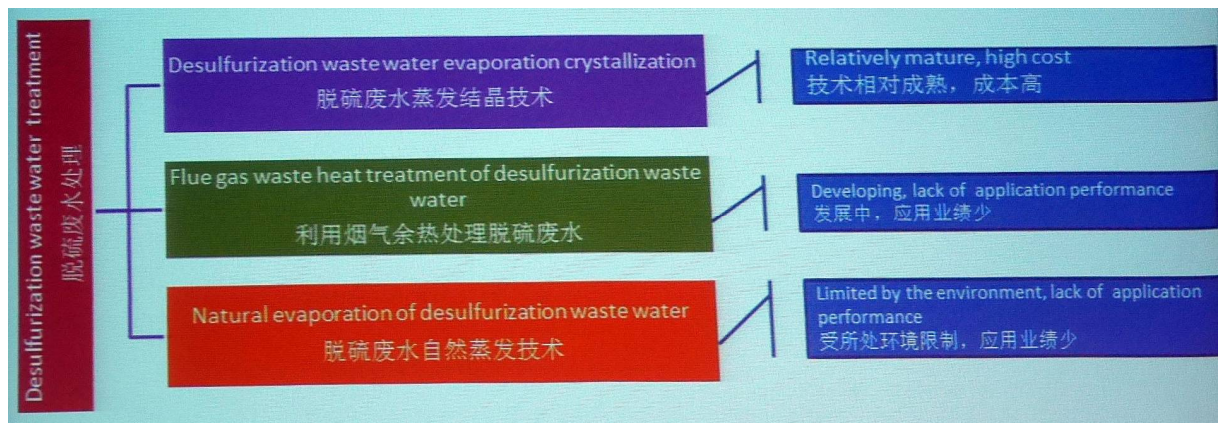
圖 8.中國大陸燃煤電廠脫硫廢水零排放處理
