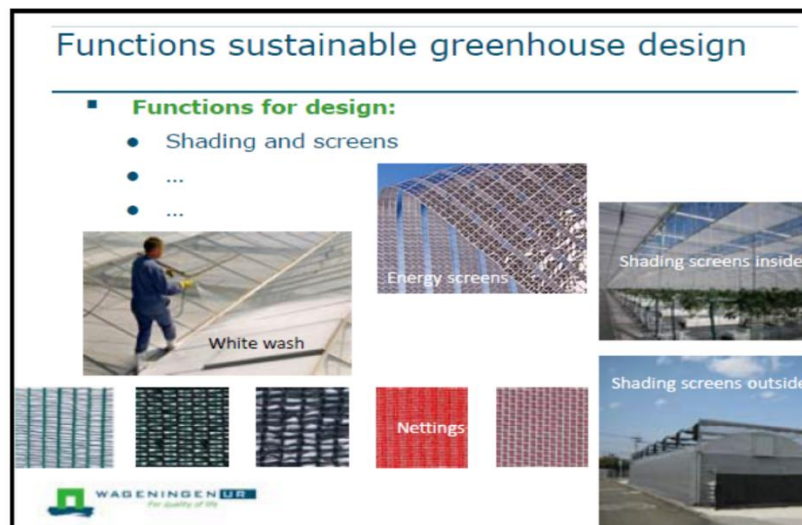
圖 6: 溫室所使用之不同遮光材料
