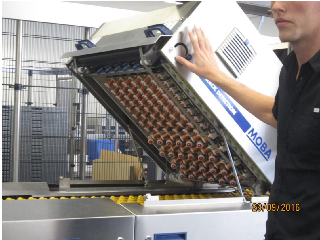
圖十六、Moba 聲納蛋殼裂紋偵測機台(偵測蛋表面有無任何破裂,從大到非常小)
