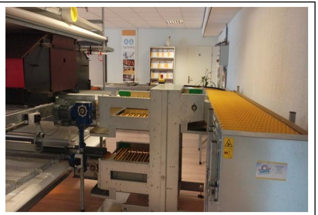
圖九、層架式飼養設備搭配後端蛋處理系統(Egg packer)
