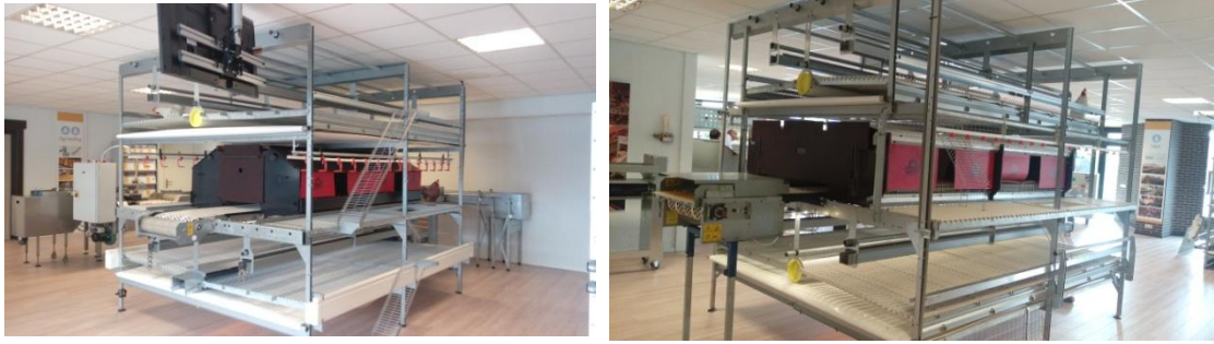
圖五、結合產蛋巢箱、集蛋帶及拖糞帶之層架式飼養設備
