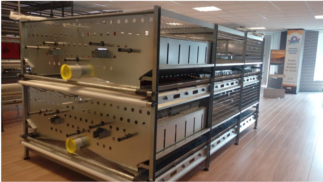
圖六、集蛋帶在兩側的層架式飼養設備
