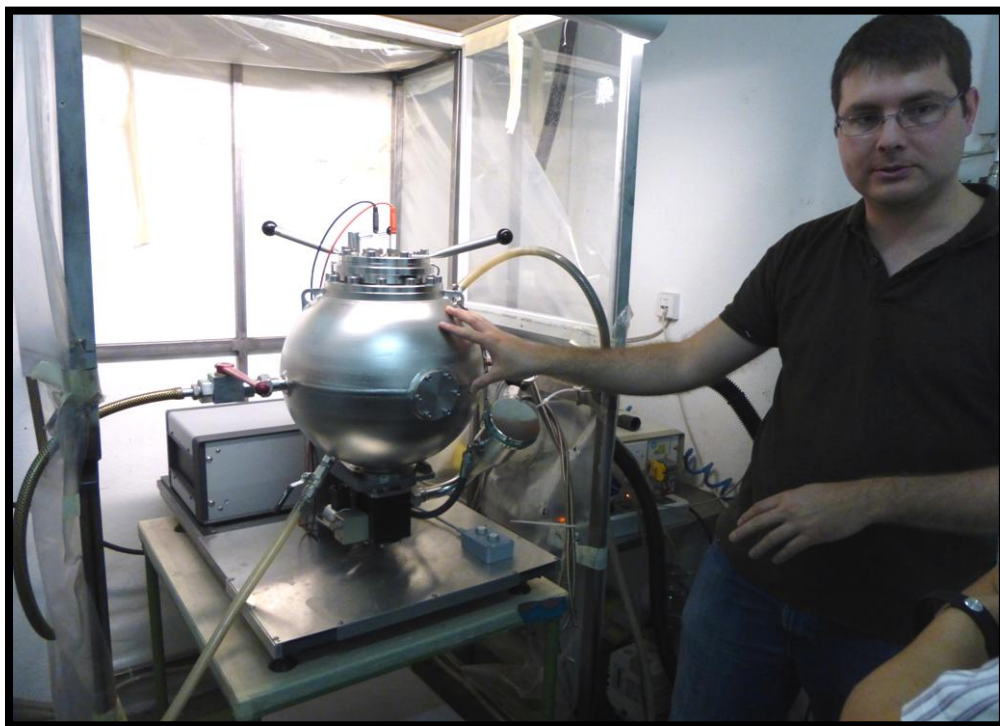
圖 3 瑞士 Adolf Kühner 公司工程師解說 20 公升爆炸鋼球及操作測試
